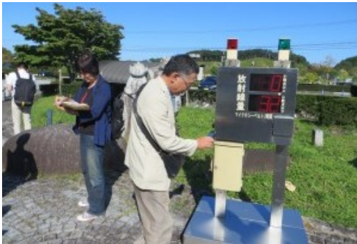
飯舘村役場前の線量計は0.32 \mu Sv(マイクロシーベルト)/hを表示。(地面より1m程度の高さが測定基準)持参の線量計を草むらに置くと数値は上昇
